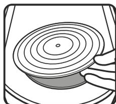
Данная система позволяет не снимать изделие с диска пока оно не подсохнет. Это особенно актуально при изготовлении крупных и тонких изделий. Для смены быстросъемного диска аккуратно поднимите его за край. При установке нового диска центральное отверстие должно совпадать с центровочным выступом на магнитном диске.
